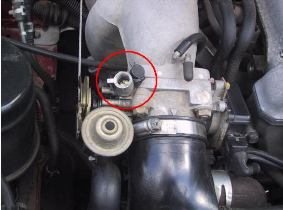
La démarche complète est détaillée dans un autre article. Elle consiste à passer l'ECU en mode test et à régler la vis d'air sur le corps de papillon. C'est tout. Temps estimé : 2 minutes pour un être humain normal, environ 5h30 pour un mécanicien Mazda de la Côte d'Azur.
